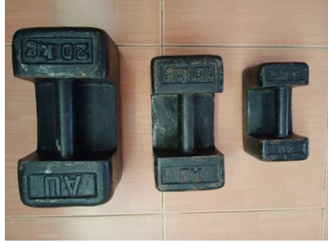
ภาพที่ 5.4 การตรวจสอบความเที่ยงตรงของเครื่องชั่งด้วยตุ้มน้ำหนักมาตรฐาน ที่มา: ภาพถ่ายโดยผู้เขียน
