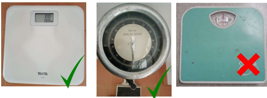
ภาพที่ 5.2 เครื่องชั่งที่เหมาะสม (✓) และไม่เหมาะสม (X) ในการประเมินการเจริญเติบโต ที่มา: ภาพถ่ายโดยผู้เขียน
