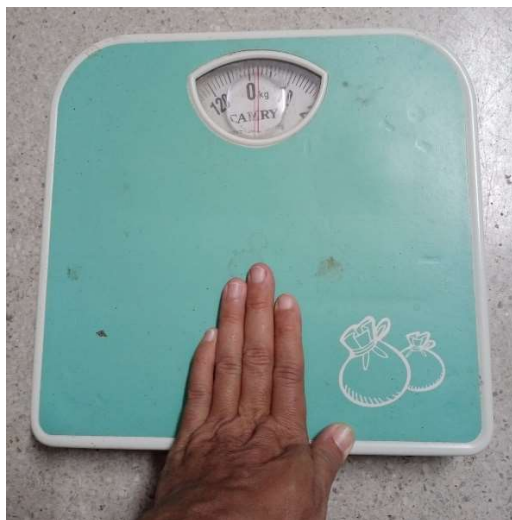
ภาพที่ 5.3 การทดสอบว่าเข็มของเครื่องชั่งกลับมาที่เลข 0 ทุกครั้ง เมื่อไม่มีน้ำหนัก ที่มา: ภาพถ่ายโดยผู้เขียน
