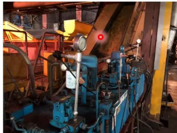
เซนเซอร์วัดค่าแรงดันในเครื่องหีบ
