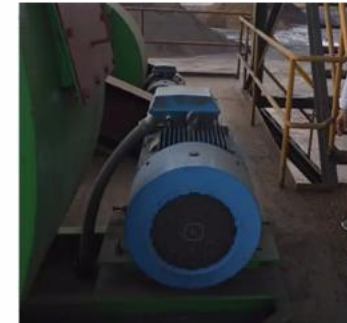
มอเตอร์ที่ใช้สำหรับการดูดเพื่อแยก Fiber กับ Nut
